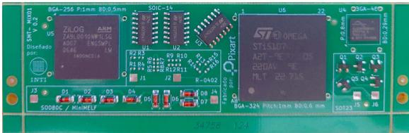
Figura 6. Una de las placas de pruebas con los encapsulados BGA ya soldados.
