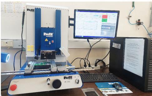
Figura 3. Equipo PACE IR3000 para soldadura y desoldadura de chips BGA.
