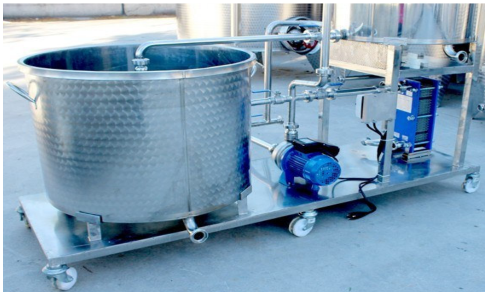
Figura N° 5: Macerador (Olla con agua caliente de 72 a 76 grados)
