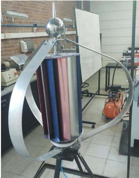
Fig. 1. Aerogenerador de eje vertical tipo Savonius/Darrieus
