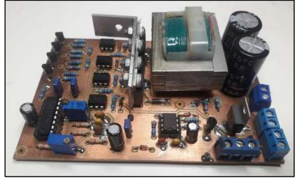
Figura 5: Placa de Fuente de Alimentación
