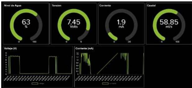
Fig. 7: Visualización de los datos en Servidor IoT.
