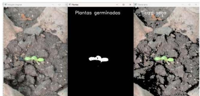
Figura 6. Segmentación de las hojas de un brote de frijol por el módulo de visión.
