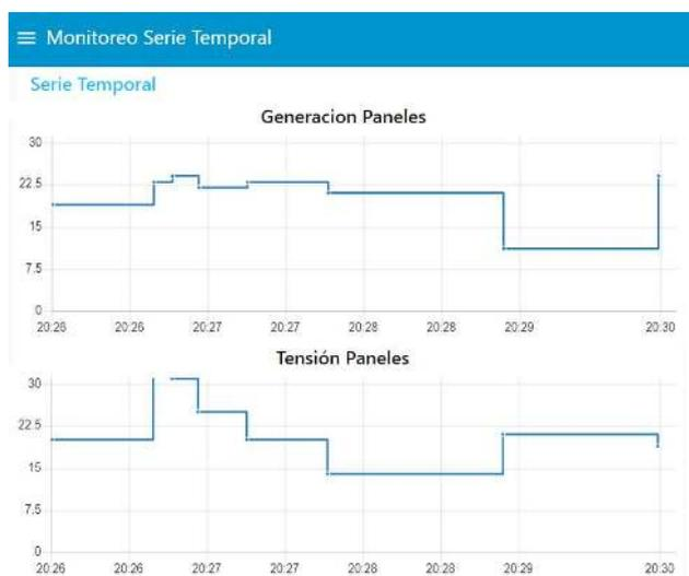
Fig. 5. Serie temporal implementada en Node-RED: generación en Watt y Tensión en Volts de paneles por cada minuto. Fuente: Los autores.
