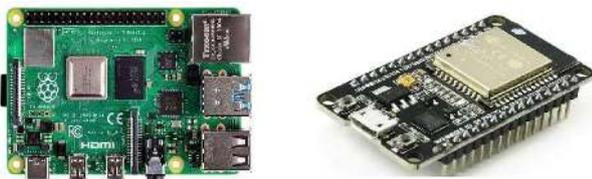
Fig. 2. Hardware: la izquierda es la Rpi4 y la derecha el ESP32. Fuente: los autores.
