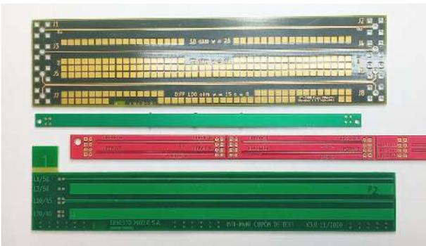
Figura 2. Varios cupones para realizar mediciones de impedancia controlada.
