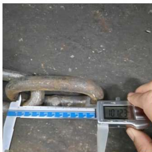
Figura N° 4 – Eslabón Medida conforme
