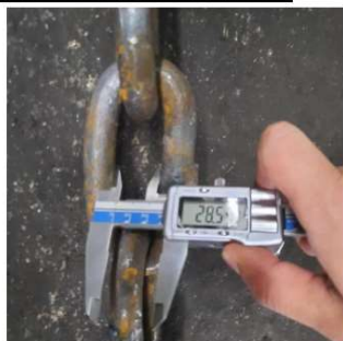
Figura N° 3 – Eslabón Medida conforme
