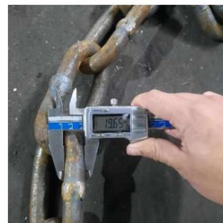
Figura N° 5 – Eslabón Medida conforme
