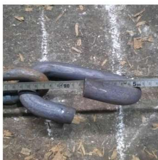
Figura N° 9 – Cadena de 5 m Medida conforme
