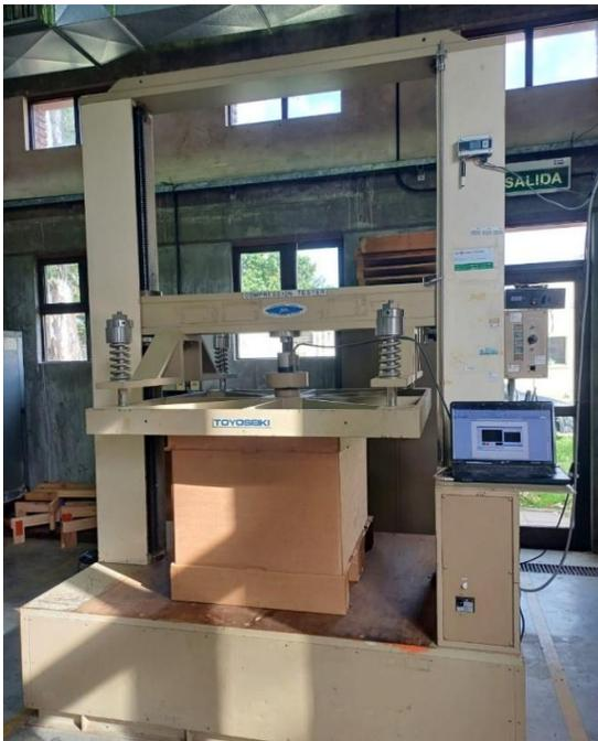
Figura 3. Vista de un ensayo de compresión con el sistema instalado
