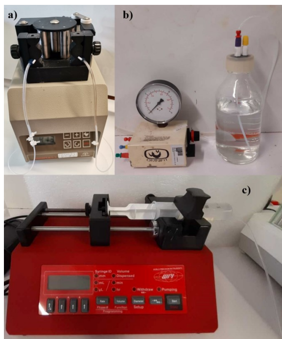
Fig. 2. (a) bomba peristáltica, (b) manómetro e frasco pressurizável com o fluido de arraste e (c) bomba de seringa.
