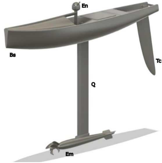
Fig. 2 Medidor de flujo basado en carenado RG65 y molinete hidrométrico tradicional.
