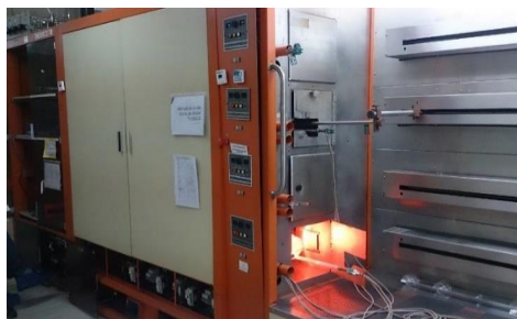
Fig. 2. Horno de alta temperatura para procesos de oxidación, difusión y recocido de contactos.
