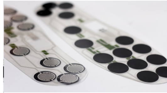
Fig. 6: Aplicación de los sensores de presión flexibles para la producción de plantillas inteligentes para prevenir amputaciones.
