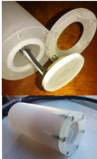
Fig. 3. Imágenes del radiómetro sumergible en proceso de armado (superior) y terminado (inferior).
