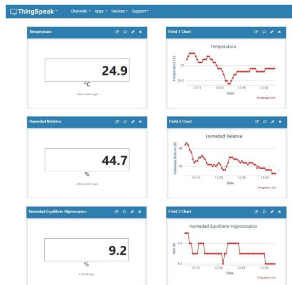
Figura 4. Plataforma ThingSpeak donde se almacenan los datos de las mediciones.
