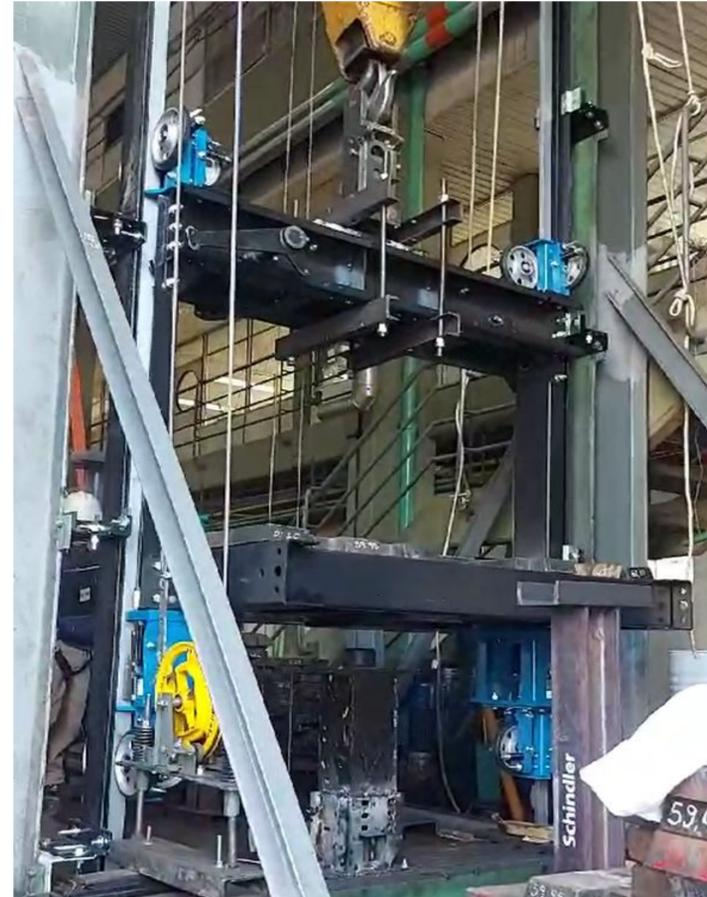
Figura 1. Torre con amortiguador bajo ensayo.
