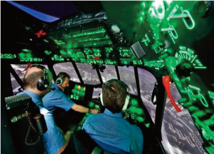
Figura 15. Simulador para helicópteros Mi-171Sh-P. Incluye un simulador de ambiente visual con pantalla esférica, impacto acústico, vibraciones, más un aula de entrenamiento con 12 Cursos de Estudio Automatizados (CEA). Fuente: Marchesini (2019).
