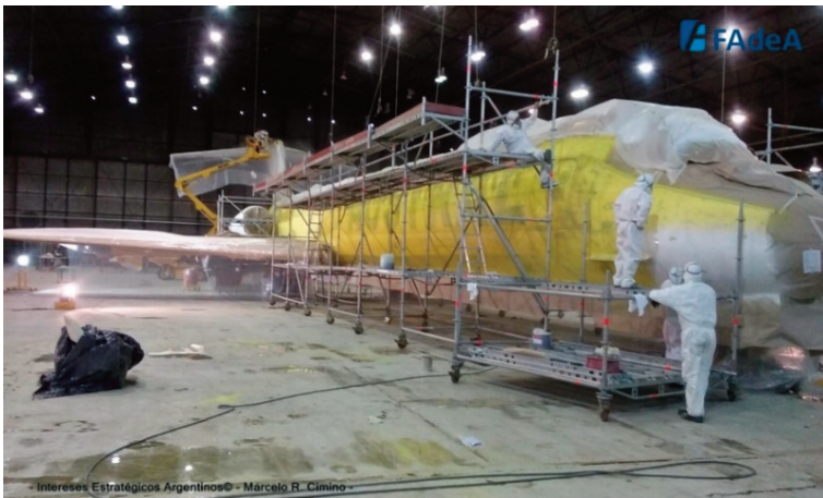
Figura 21. Pintura de un MD-83 de Andes Líneas Aéreas en Fadea. Hangar 117, diciembre de 2015. Además de pintar, implica desarrollar fabricantes nacionales, proveedores certificados de pintura aeronáutica. Fuente: Cimino (2015).
