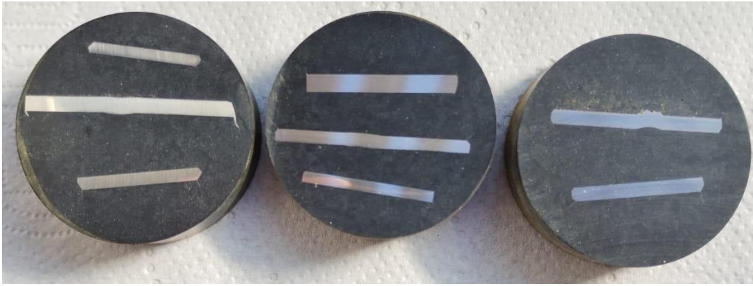
Figura 17: Inclusiones de las probetas “Buena”, “Intermedia” y “Mala”, respectivamente.
