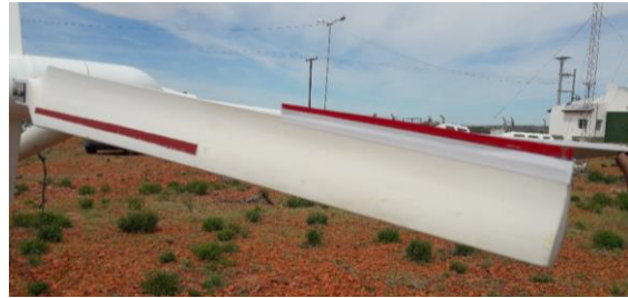
Figura 4: aditamentos para provocar una capa límite turbulenta y reducción de espesor de borde de fuga.
