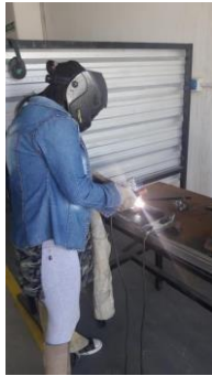
Figura 2: Soldando un portamacetas
