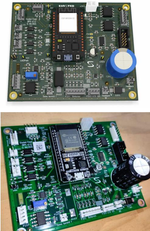
Figura 2: Modelo 3D de la placa de control (arriba) y foto (abajo)
