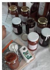
**Figura 4:** Instrumental portátil de laboratorio: refractómetro digital.
