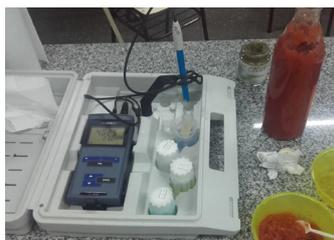
**Figura 3:** Instrumental portátil de laboratorio: peachímetro digital.
