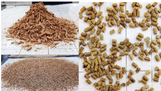
**Figura 1: Biomasa y pellets obtenidos en los ensayos de conformado de pellet.**
