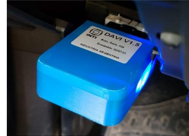
Dispositivo DAVI conectado al conector OBDII en un vehículo.
