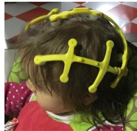
Figura 4: Colocación del prototipo de casco EEG y porta electrodo en paciente pediátrico.
