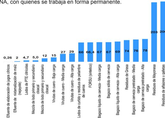
Figura 1. PBM de los ensayos en batch de monodigestión de sustratos. Valores expresados en  $\text{m}^3_{\text{CH}_4}/\text{t}_{\text{sustrato}}$
