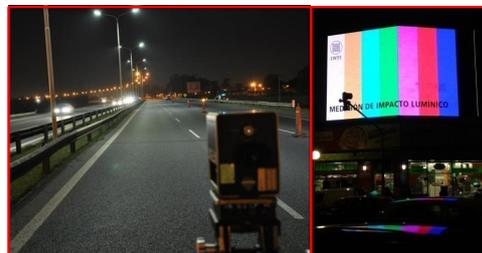
Figura 4: Ejemplos de usos de luminancímetros de referencia del Laboratorio de Radiometría y Fotometría calibrados con los patrones de luminancia: medición de luminancias de calzada en autopista y de carteles publicitarios
