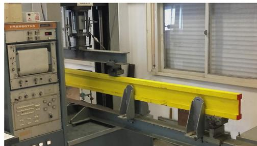
Determinación de modulo de elasticidad por ensayo de flexión
