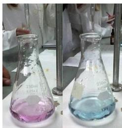
Fig 1. Cambio colorimétrico del indicador NET. Volumetría de complejos para dureza total.
