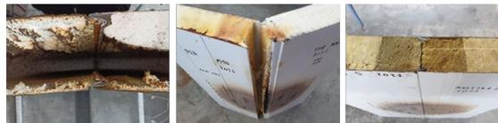
Resultado de paneles sándwich luego del ensayo en el H-TRIS: EPS, PIR y lana de roca
