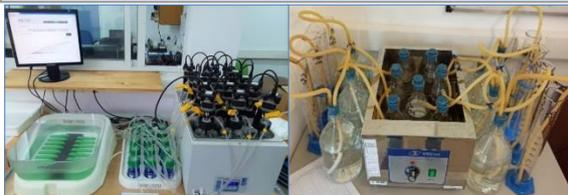
Imagen 1. Equipos de INTI para medición del PBM de sustratos. Izq.: AMPTS II de Bioprocess Control. Der.: Método volumétrico por desplazamiento.
