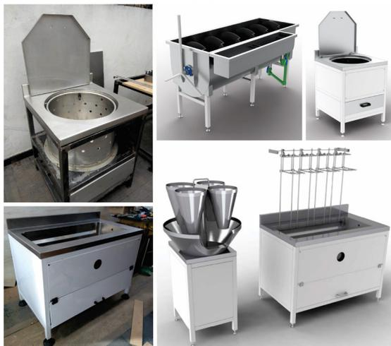
Diseño de equipos y prototipos de peladora y escaladora de pollos.
