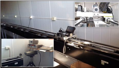
Figura 1: Banco de trabajo de 10 metros. Extremo superior derecho: detalle del carro móvil. Extremo inferior izquierdo: Sistema láser de referencia (Sr).
