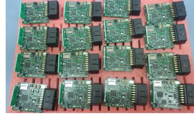
Fabricación de prototipos (Placas ensambladas).
