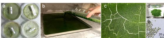
**Figura 3.** *Etapa 1.* Placas de Petri liofilizadas (a). *Etapa 2.* Congelamiento del cultivo (b), producto de la liofilización (c), muestra para caracterización (d) e imagen al microscopio óptico, 1000x (e).
