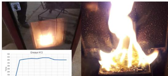
Fig. 5 - Pruebas de combustión en estufa de pellet, análisis de comportamiento de llama y Ensayo N°2 de combustión a Potencia térmica nominal (PTN).
