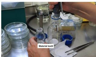
Figura 1. Inoculación de cada réplica de las muestras 1, 2 y sus respectivos controles negativos con los organismos de prueba. Tiempo de contacto "0" y "24" h. Controles positivos; tiempo de contacto "0" h.
