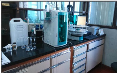
Cromatógrafo iónico del laboratorio Química del Agua
