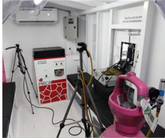
Figura N° 3: Unidad Scrubber PIRCA Safety®, y distribución de sensores e instrumental dentro del refugio PIRCA Safety® modelo P-RMS.
