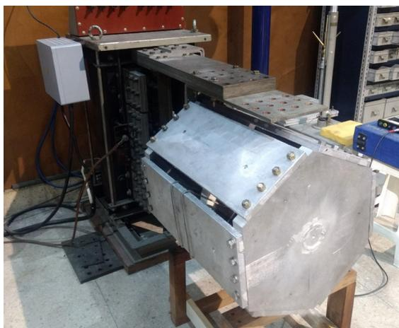
La fuente de corriente es un transformador bifásico con su bobina secundaria en cortocircuito mediante una jaula hexagonal para minimizar la impedancia del lazo.
