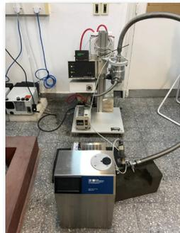
Figura 2.b: Sistema K38 conectado a bomba turbomolecular.
