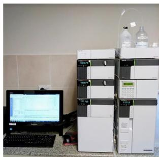
Fig 2. Cromatógrafo de iones Prominence® de Shimadzu
