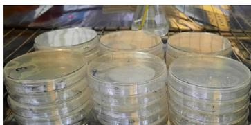
Figura 4. Período de incubación de 48 h a  $35 \pm 2$  °C, para las muestras 1 y 2, controles negativos y controles positivos.
