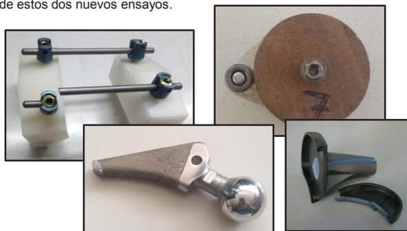
Rotura de implantes durante ensayos de fatiga
