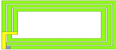
Modelo de antena loop de aplicación NFC
