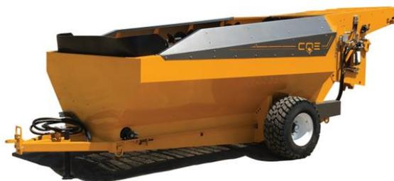
Fig 3: Carro colector anexo a la cosechadora.
