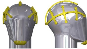
Figura 3: Colocación del casco EEG y porta electrodo en cabeza.
