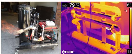
Fig. 3 - Gasificador YunGas 1.0 y estudios termográficos de las pruebas de operación para identificar puntos de mejora.
