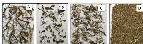
Figura 2. Estudio fotométrico por dispersión manual de la "fracción media chipeada". A) Ramas finas y astillas. B) Hojas. C) Pabillos y astillas. D) Finos.
