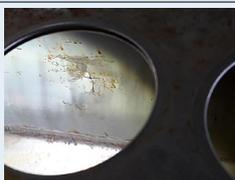
Fisuras típicas que se identifican en el cuerpo cilíndrico. En este caso lejos del cordón de soldadura, vista de la superficie interior y exterior del tanque.
