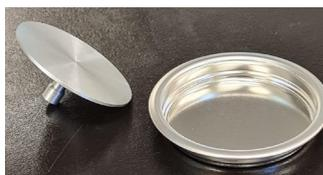
Figura 1: Geometrías descartables utilizadas para realizar los ensayos de reología en resinas.
