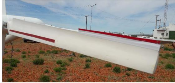
Figura 3. Aspa de aerogenerador con modificaciones destinadas a reducción de emisiones sonoras.
