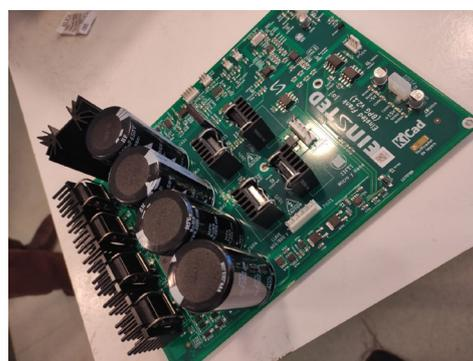
Placa de potencia. Arriba: render de la herramienta KiCad. Abajo: circuito fabricado
