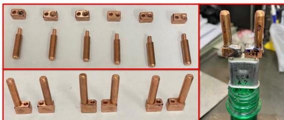
Figura 2: Adaptaciones eléctricas fabricadas con cobre.
