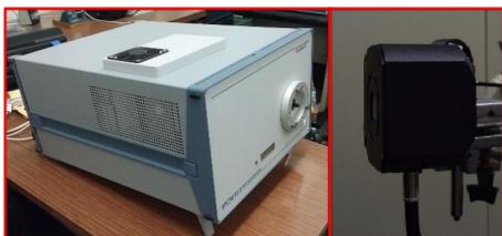
Figura 1: Espectro-radiómetro de referencia y su esfera integradora.
