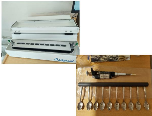
Equipo OPTIGRAPH: celdas de medición de 10ml y juego de cucharas para mezclar el cuajo.
