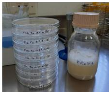
Figura 2. Neutralización del tratamiento bactericida del material textil con una solución neutralizante.
