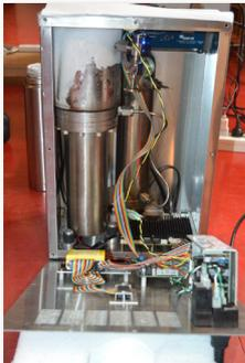
Figura 2.a: Interior del sistema K38 con presencia de hielo y humedad.
