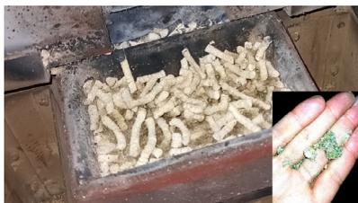
Fig. 4 –Problemas de acumulación de cenizas en parrilla (estufa alim. mecánicamente, El Cacique)
