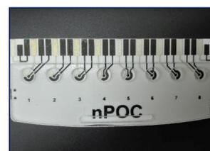
Figura 5. Imagen del cartucho con los electrodos utilizados para la medición electroquímica. Se utilizó un electrodo de referencia de Ag/AgCl, un electrodo de trabajo y contraelectrodo de carbono.
