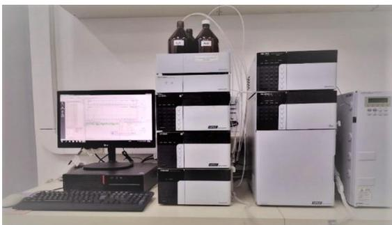
Figura 1: Cromatógrafo líquido con detector de índice de refracción (HPLC-RID) Shimadzu RID-20A.
