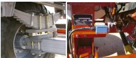
Fig 2: Detalles Celdas de Carga y Data Logger.
