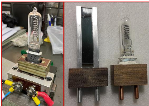
Figura 3: Prototipo de montaje en un material aislante (izquierda). Sistema jig junto con lámpara unida con cerámica a la adaptación G22 y a la cubeta de micarta (derecha).
