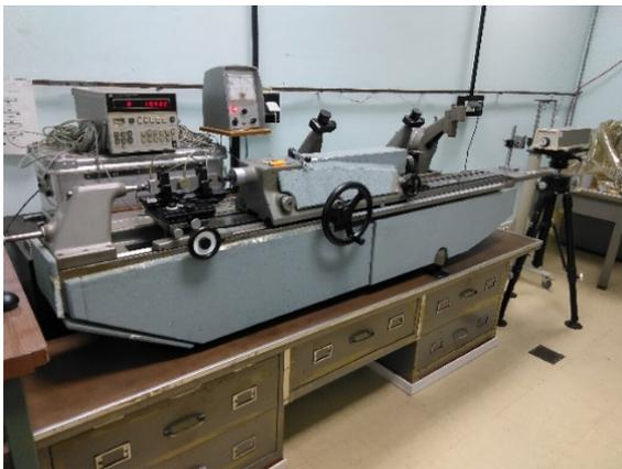
Figura 1. Sistema de calibración de bloques largos.
