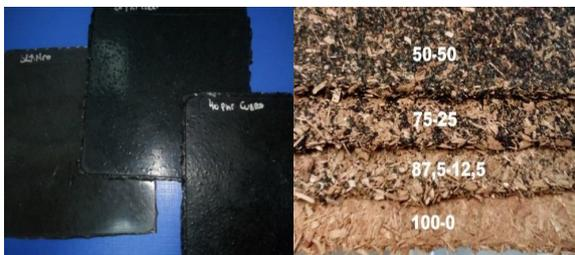
Figura 2: Planchas normalizadas con caucho vulcanizado (izq.) y Tableros aglomerados con madera (der.), conteniendo cuero residual molido.
