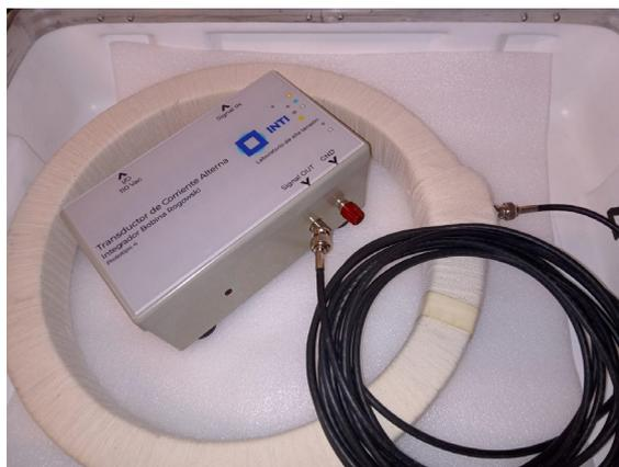
Bobina de Rogowski de referencia y el integrador activo. Ambos elementos fueron diseñados y fabricados en INTI.
