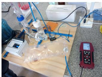
Foto 6. Caudalímetro hidráulico (izq.) – Medidor de gases (der.)
