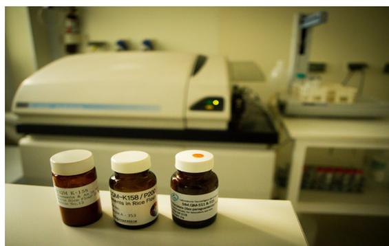
Figura 1: Frascos Interlaboratorio junto al equipo ICP-MS utilizado para realizar mediciones en el orden de partes por billon
