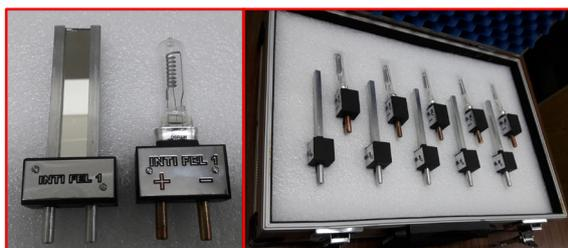
Figura 4: Patrones terminados y los cinco conjuntos lámpara-jig preparados para ser enviados al PTB.
