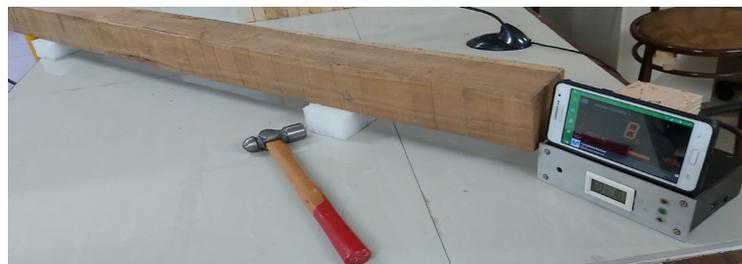
Determinación de modulo de elasticidad con aplicación DaTuner
