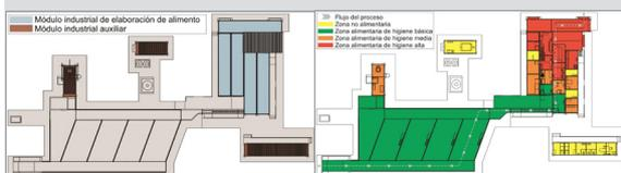
Diseño de planta modular y zonificación de áreas según nivel de higiene requerido.
