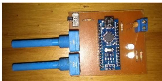
Generador de señal senoidal variable en frecuencia y amplitud
