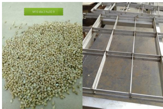
Figura 1: Muestras de ensayos con mijo y construcción de estructura de falso fondo del germinado.
