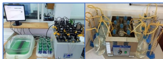
Imagen 1. Equipos de INTI para medición del PBM de sustratos. Izq.: AMPTS II de Bioprocess Control. Der.: método volumétrico por desplazamiento.
