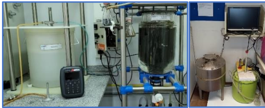
Imagen 2. Biodigestores experimentales de INTI para ensayo semicontinuo de generación de biogás
