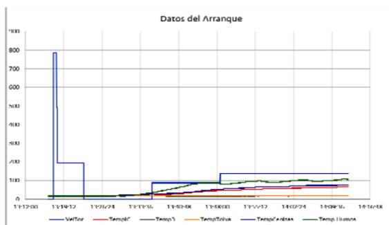
Figura 3: Prueba de ignición a dos velocidades de acuerdo a los cálculos teóricos realizados por Verayre.
