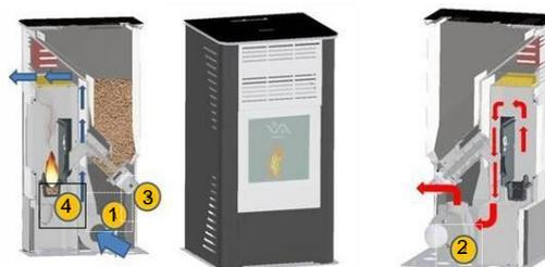
Figura 1- Diseño 3D 1) Ent. de aire, 2) Sal. de humos, 3) Tolva de comb., 4) Cám. de comb. (Productos Verayre)
