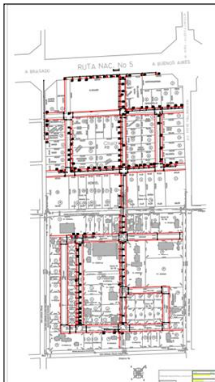
Figura 1: Plano de iluminación pública del PIC.
