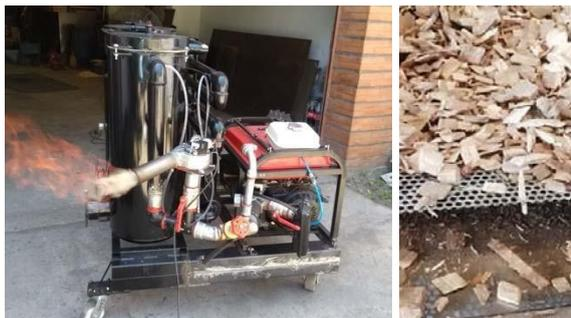
**Imagen 2 - Pruebas de gasificación preliminares con la unidad de I+D y el chip de madera s/norma**
