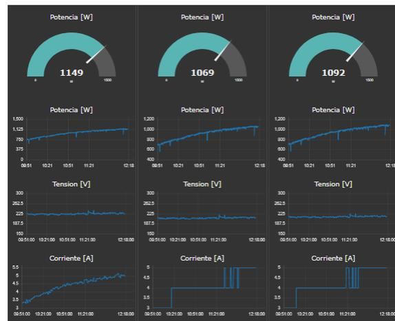
Figura 2: Dashboard mostrando los datos de tres nodos.
