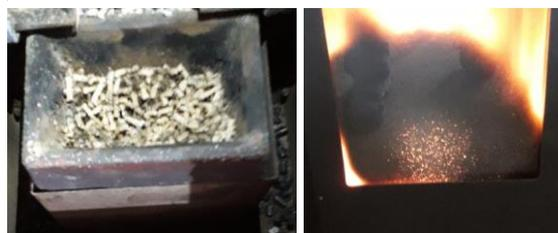
Fig. 5 – Ensayo: Menor acumulación de cenizas y problemas detectados en algunos de los ensayos.
