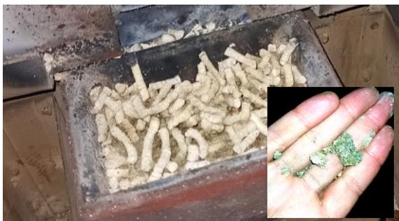
Fig. 3 - Problemas de acumulación de cenizas en parrilla (estufa alim. Mecánicamente, El Cacique)
