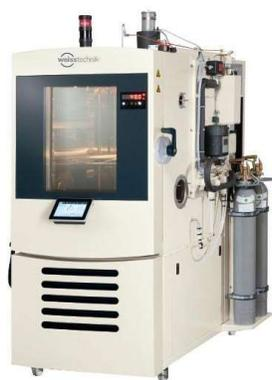
**Figura 2:** Cámara climática para baterías de Li.
