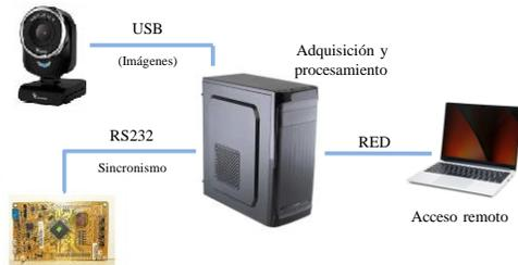
**Figura 2: Hardware mínimo para la prueba del algoritmo crítico..**
