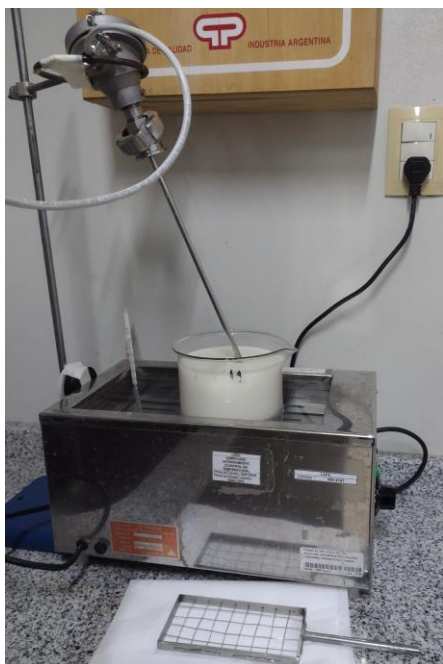
Figura 1: elaboración de miniquesos. Medición de tiempo de coagulación.
