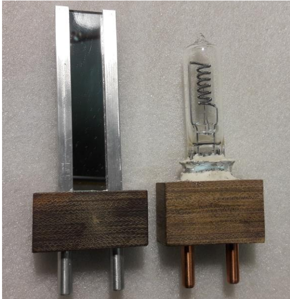
Figura 4: jig junto con lámpara unida con cerámica a la adaptación G22 y a la cubeta de micarta.
