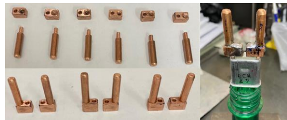
Figura 3: Adaptaciones eléctricas fabricadas con cobre.
