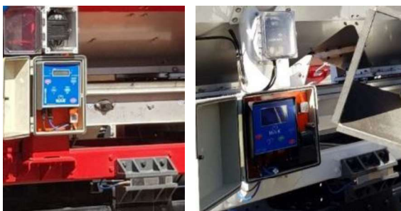
Fig 1: Celda de Carga, Data logger, GPS y Chip Celular.
