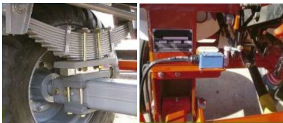
Fig 2: Detalles Celdas de Carga y Data Logger.
