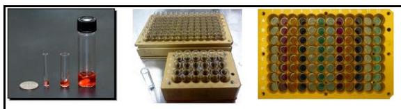
Figura 1: (izq.): viales de 8 mL, 1 mL y 250 µL. del Lab. de HTS; (centro): bloques de reacción de 24 y 96 posiciones con viales de 1 mL; (der.): ejemplo de bloque de 96 posiciones luego de ser dosificado.
