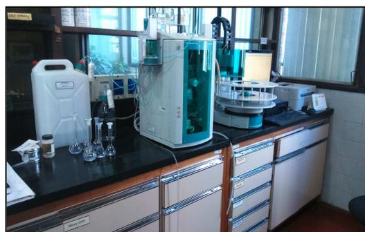
**Fig. 1. Cromatógrafo iónico del Lab. Química del Agua.**
