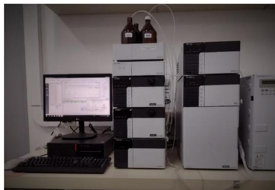
Figura 1: Cromatógrafo líquido con detector de índice de refracción (HPLC-RID) Shimadzu RID-20A.
