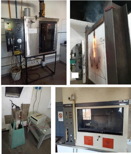
Figura 2: Equipos utilizados: cámara de humos, H-TRIS, incombustibilidad y propagación de llama.
