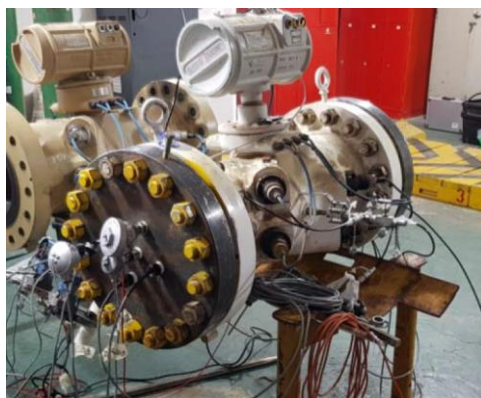
Figura 1: Medidor ultrasónico preparado para el ensayo.
