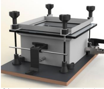
Figura 1: Cámara de gases para prueba de medidores.
