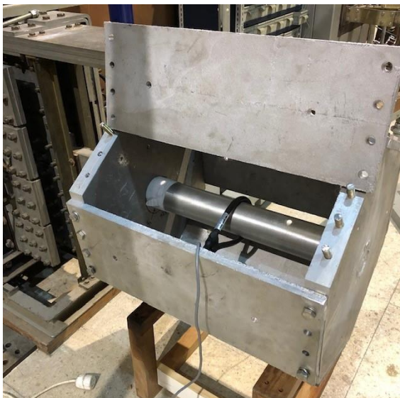
Figura 2: jaula hexagonal y coaxial conectada al secundario del transformador de la fuente de corriente.
