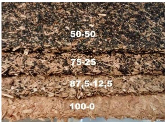
Figura 2: Tableros con las diferentes proporciones de madera-cuero.
