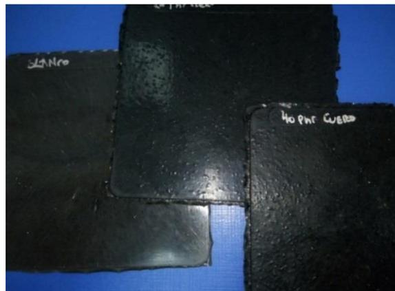
**Figura 1: Planchas vulcanizadas y normalizadas de caucho con cuero molido.**
