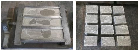
Figura 2: Morteros normalizados (izq.); Probetas para medida de resistencia a la compresión (der.).
