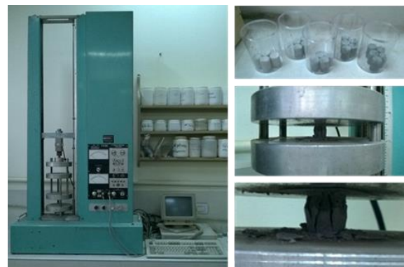
Figura 1: Equipo utilizado para medir la resistencia a la compresión y probetas (etapa preliminar).
