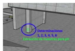
Figura 1. kT 1-6: Columna sobre Av Libertador. Estimación del espesor de recubrimiento y pH
