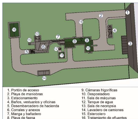
Figura 1: emplazamiento planta industrial FRM.
