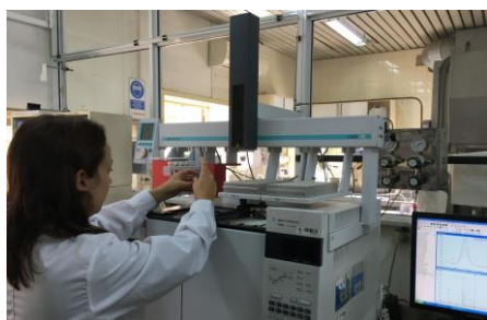
Imagen 1: Cromatógrafo Agilent Technologies GC5890A MSD7890C utilizado en la validación
