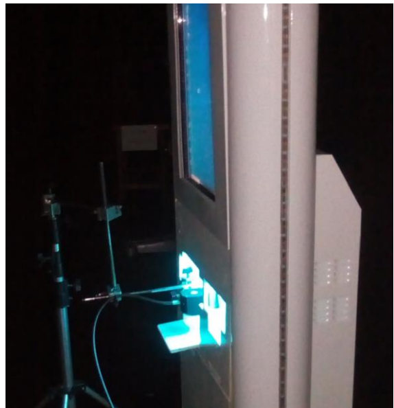
Figura 9: Prototipo de controlador automático de pasaportes equipados con lámparas de desinfección por UVC para sus teclados.
