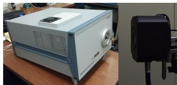
Figura 2: Espectro-radiómetro de referencia y su esfera integradora.
