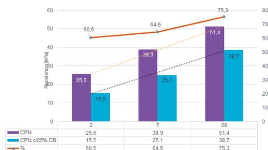
Figura 2: Resistencia a la compresión IRAM 1622.
