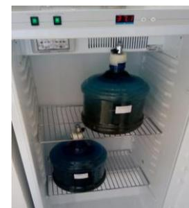
Como inóculo se utilizó una mezcla de estiércol vacuno y digestato de un biodigestor de escala real en una proporción 50:50, con una cantidad total de 50% (m/m) de SAR inicial en las dos primeras experiencias y 30 % (m/m) en la última.
