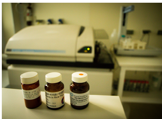
Figura 1: Frascos de Interlaboratorios junto a uno de los equipos (ICP-MS) que se utiliza para determinaciones de trazas metálicas en el orden de las partes por billón.
