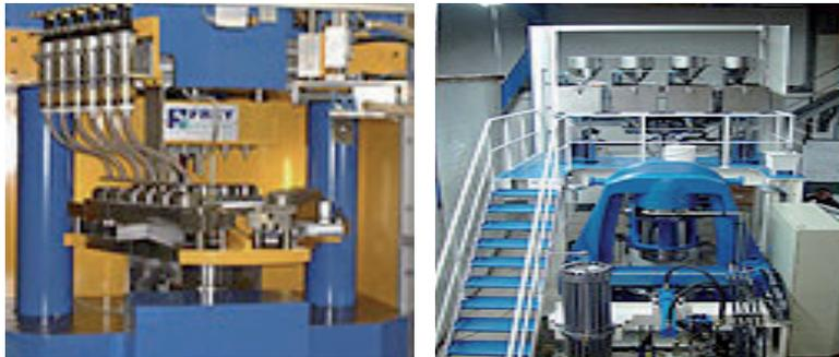
**Figura V.49:** Fotografías de prensas C.I.P. dry bag (bolsa seca) catálogos de EPSI Inc
