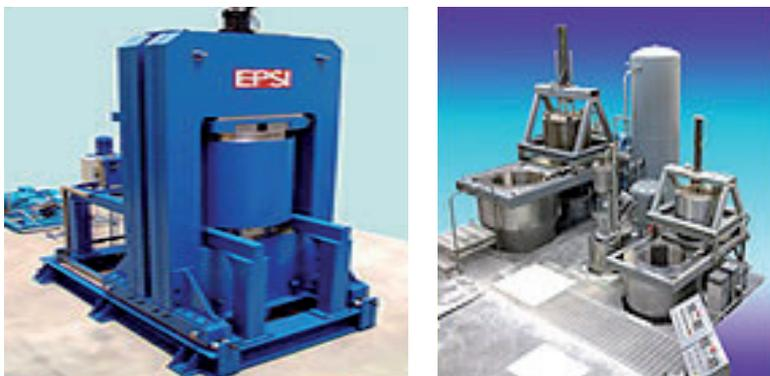
**Figura V.48:** Fotografías de prensas CIP wet bag (bolsa húmeda o bolsa mojada)
