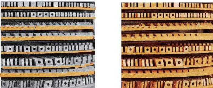
**Figura IX.10:** Fotografía modificada de una carga de insertos sin revestimiento (antes de ingresar al horno) izq. y con revestimiento de TiN (al salir del horno) der.
