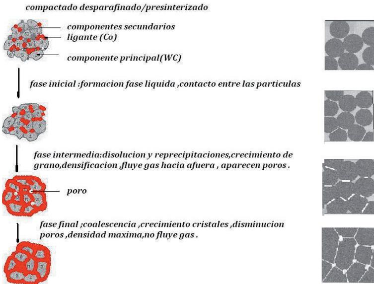
Figura VI.22: Etapas de sinterización con fase líquida
