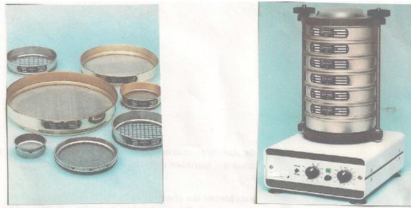
**Figura IV.16:** Mallas con marcos (tamices) y maquina vibradora (catálogo Granulometría (R3)-Rheinisch Straße 36-W. Germany)
