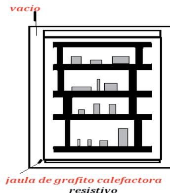
**Figura VI.4:** Esquema de un horno de sinterización de metal duro de WC con calentamiento resistivo
