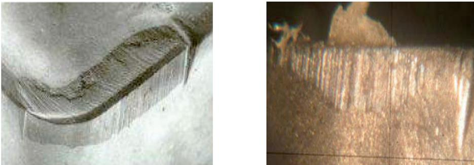
Figura VIII.11: Fotografías de desgaste producido en el flanco de incidencia en una herramienta
