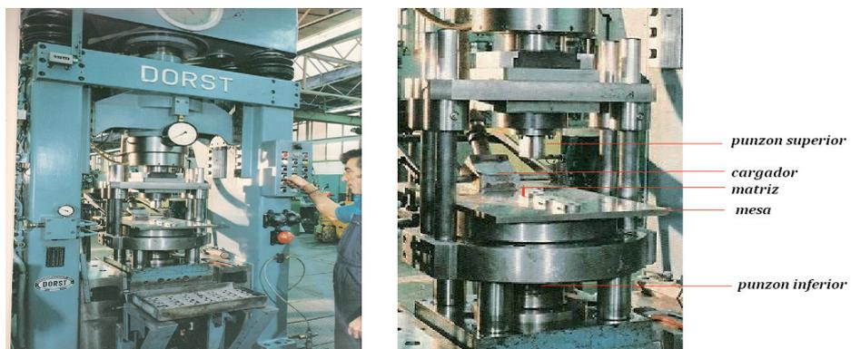
**Figura V.35:** Fotografía de prensa pulvimetalúrgica (Catálogo de Dorst – Maschinen und Anlagenbau – Otto Dorst Und Dipl.-Ing. Walter Schlegel GMBH &Co.) y detalle del portamatrices
