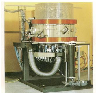
**Figura IX.24:** Fotografías de herramientas de corte obtenidas por vaporización (izq.) y Horno PVD por vaporización (der.), ambas del catalogo de Stock Die Ideenfabrik, TiN Werkzeuge
