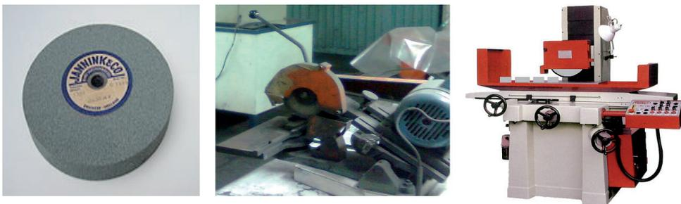
**Figura V.56:** De una piedra o muela de diamante (izq.), máquina cortadora (centro) y una máquina rectificadora (der.)
