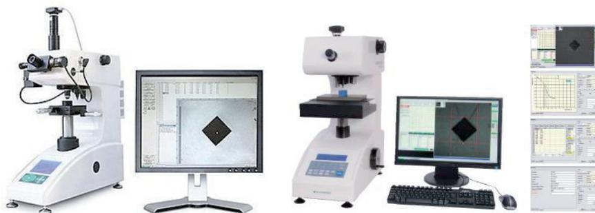
Figura VII.9: Fotografía de durómetros Vickers (catalogos Maastrich y Metrotec)
