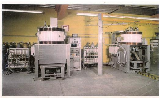
**Figura IX.25:** Diagrama de la técnica PVD por Sputtering (izq.) y horno para este proceso (catalogo Fette) (der.)
