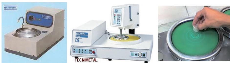
**Figura VII.3:** Fotografías de las pulidoras metalograficas (Tecnimetal representante Presi Mecapol) (izq y centro) y pulido manual de una muestra testigo (der)
