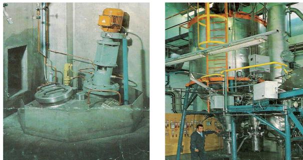
**Figura V.16:** Recipiente de presión de una torre de secado por spray (izq.) y equipo de secado por spray (der.) (catálogo de Metallwerk Plansee Aktiengesellschaft)
