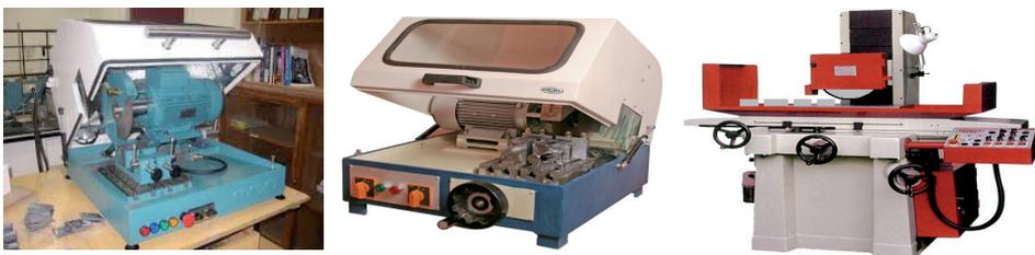
**Figura VII.2:** Cortadoras de disco de diamante y obtención de muestra testigo (izq. y centro) y maquina rectificadora (der.)
