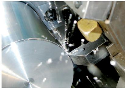
**Figura IX.33:** Fotografía de un inserto con borde cortante de PCBN (nitruro de boro cubico policristalino)
