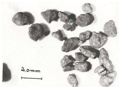
**Figura II.30:** Microfotografía x 7,5 Pellets ( $W_2C$ -WC)
