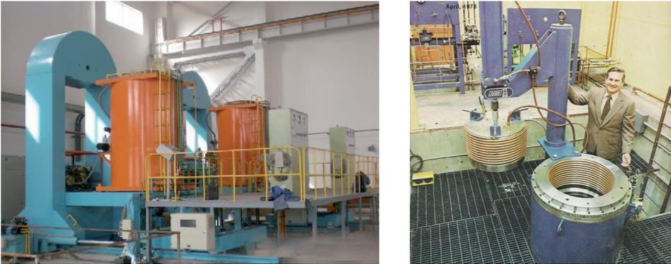
**Figura VI.30:** Fotografías de hornos H.I.P. a cielo abierto
