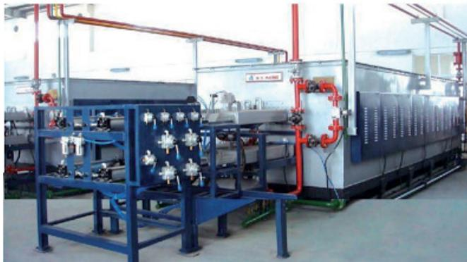
Figura II.19: Horno moderno de reducción (Fuente: Advanced Corporation For Materials & Equipments de Hunan, China Continental)
