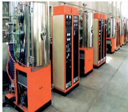
**Figura IX.29:** Hornos de tecnología PVD por ion plating catálogo de Huicheng Vacuum Technology Co Ltd. Guang Dong, China (izq.) y catálogo de Sun Win Technology Co (der.)
