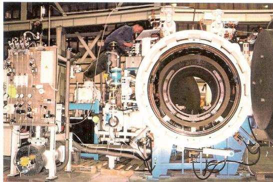
**Figura VI.10:** Fotografía de un horno de sinterización de ciclo completo (catálogo de ALD Vacuum Technologies GmbH)
