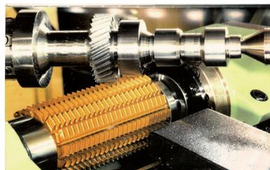
Figura IX.14: Fotografías de revestimientos y de una herramienta revestida con TiN
