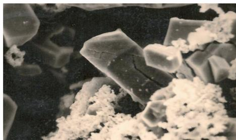
**Figura II.21:** Microfotografía x 1300 de óxido de tungsteno  $W_4O_{11}$
