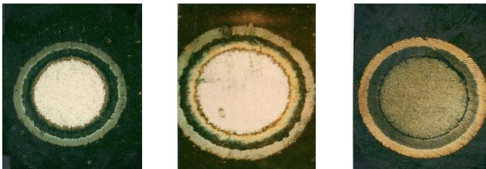
Figura IX.39: Fotografías de algunos revestimientos con hoyos (improntas) producidos por la técnica Calotte
