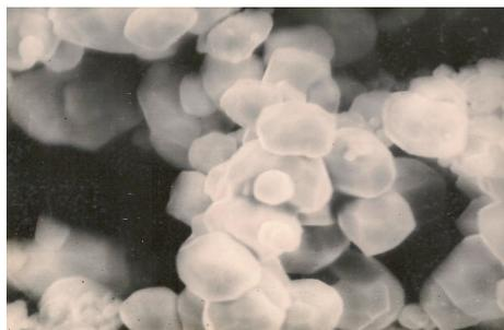
**Figura II.23:** Microfotografía x 4800 de Tungsteno 3,50  $\mu\text{m}$
