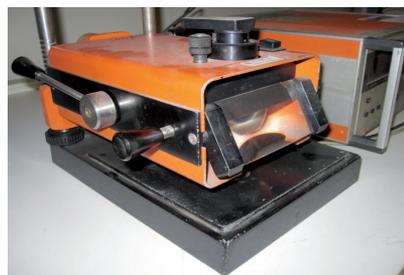
Figura IX.41: Fotografías de un equipo Betascope (R) modelo 850 (gentileza Pulvimetalurgia Rossi S.A.C.I.F.)
