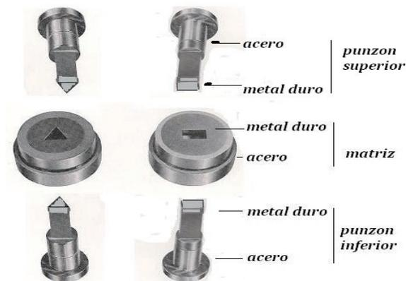
Figura V.30: Fotografía de matrices de metal duro y sus punzones
