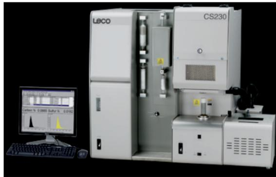
Figura IV.12: Equipo para la determinación del contenido de carbono (C) (catálogos de Leco Corporation)
