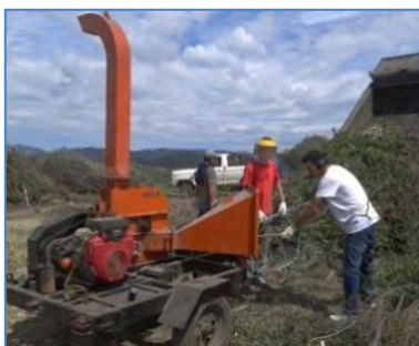
Figura 5 Chipeado de restos de poda
