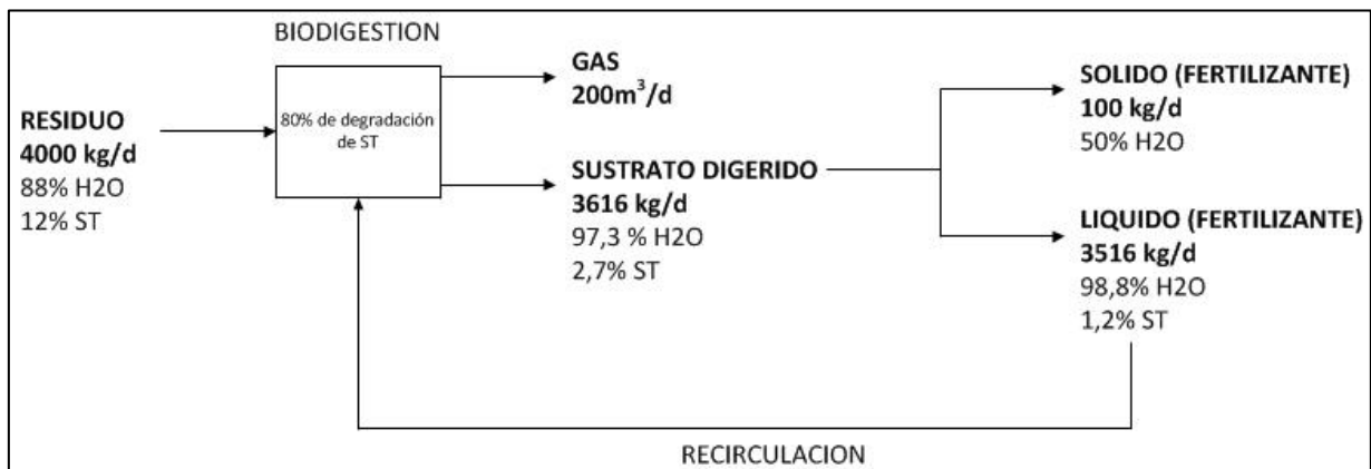
Figura 2: Esquema del proceso de biodigestión desde la entrada del sustrato hasta la obtención del producto final.
